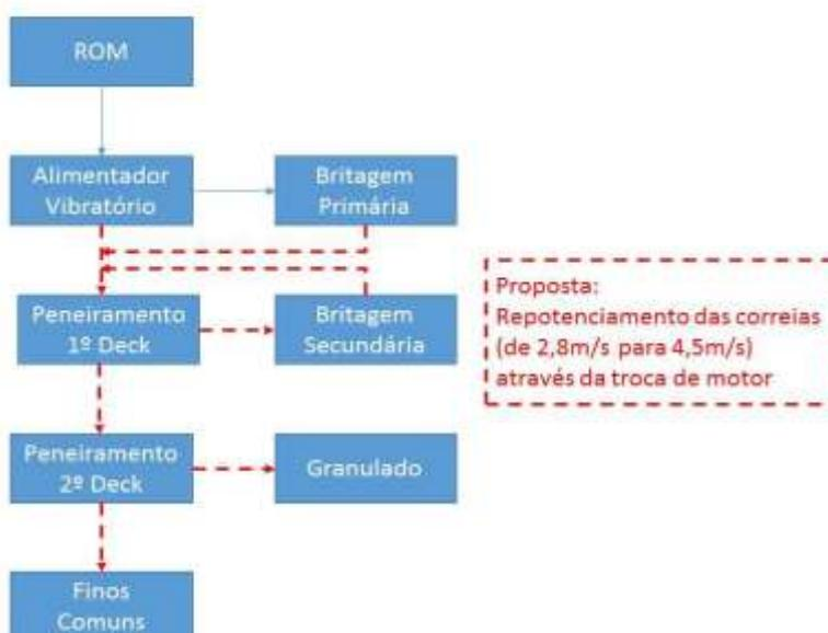
Figura 6: Adequação do processo da PSM.
