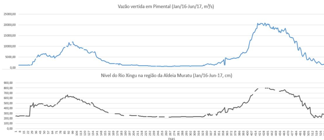
Figura 4. Variação da vazão vertida em Pimental e do nível d'água do rio Xingu na aldeia Miratu (Volta Grande) no período entre Jan/2016 e Jan/2017. Fonte dos dados: Norte Energia S.A. e Monitoramento Independente.
