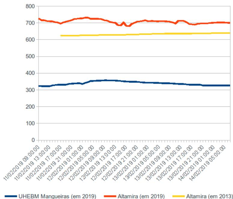
Figura 2 - Gráfico com medições da Cota Fluviométrica em 72h da Estação UHEBM Mangueiras no mês de fevereiro de 2019 e da Estação Altamira no mês de fevereiro de 2013 e 2019. Fonte: ANA, 2019.
