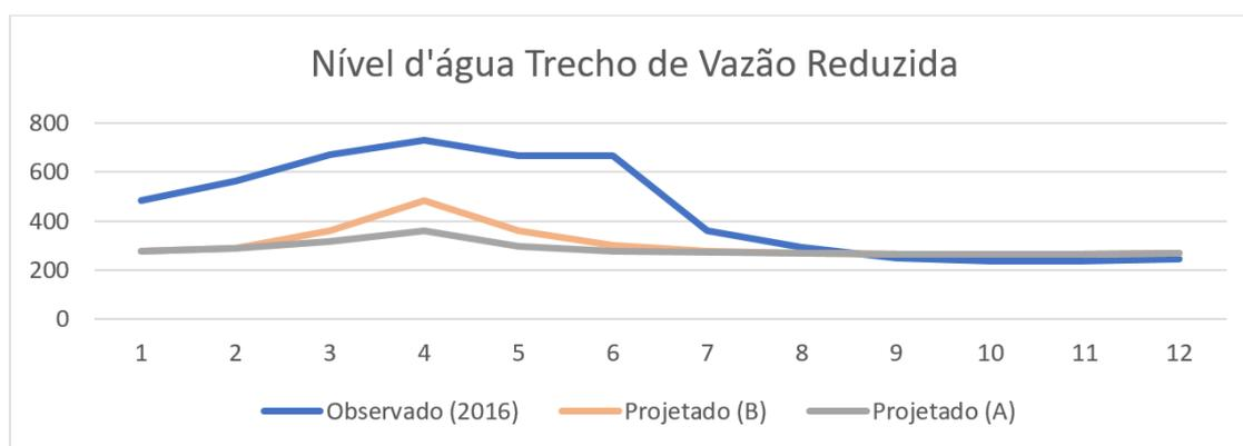
Figura 6. Níveis d'água médios mensais estimados para o rio Xingu na aldeia Mĩratu sob os hidrogramas A e B, em comparação com a variação do nível d'água do ano de 2016.
