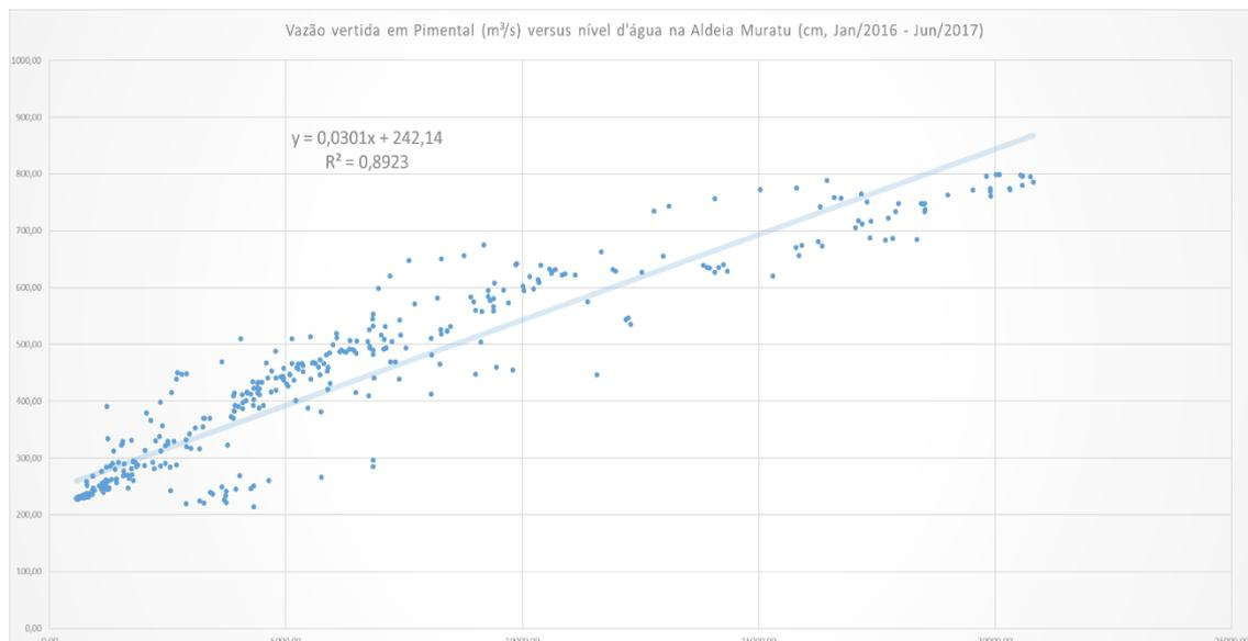
Figura 5. Relação (regressão linear) entre vazão vertida em Pimental e nível d'água na aldeia Mĩratu (Volta Grande).
