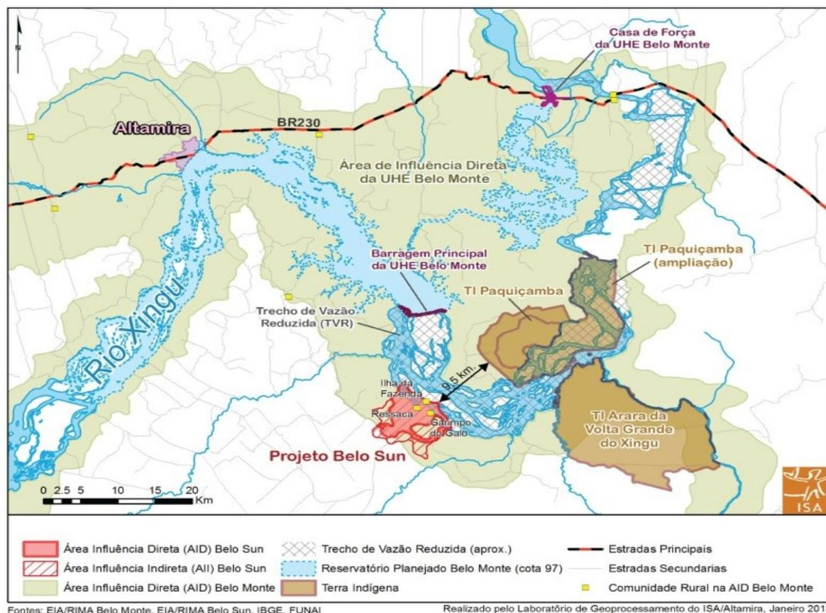
Desde novembro de 2015, o rio Xingu foi definitivamente barrado e o fluxo de vazão das águas passou a ser controlado pela Norte Energia, empresa concessionária da UHE Belo Monte. Na medida em que as turbinas vão sendo instaladas, mais água passa a ser desviada para o canal de
