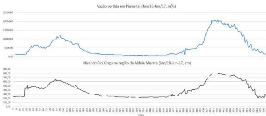
Figura 4. Variação da vazão vertida em Pimental e do nível d'água do rio Xingu na aldeia Míratu (Volta Grande) no período entre Jan/2016 e Jan/2017. Fonte dos dados: Norte Energia S.A. e Monitoramento Independente.
