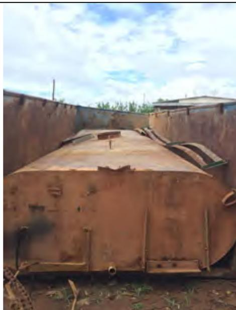
Foto 28. Tanque acoplado com soldas no interior da caçamba (11500 l)
