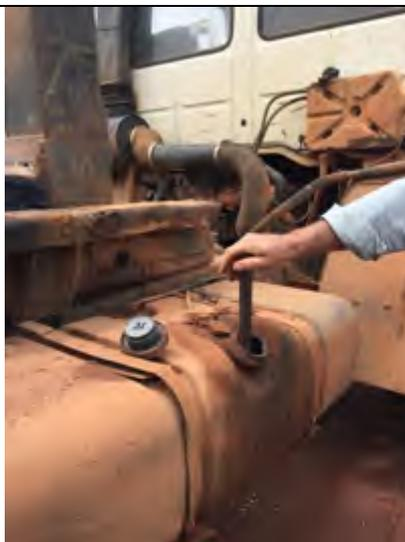
Foto 23. Tanque de combustível do caminhão (amassado e com sinais de vazamento).
