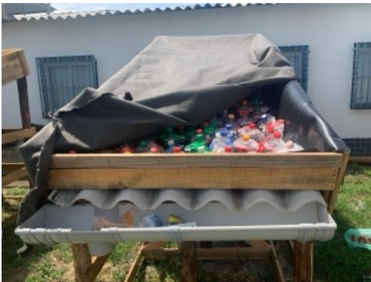
Figura 6. Protótipo 1 na etapa de colocação do geotêxtil (Fonte: EcoClima)
