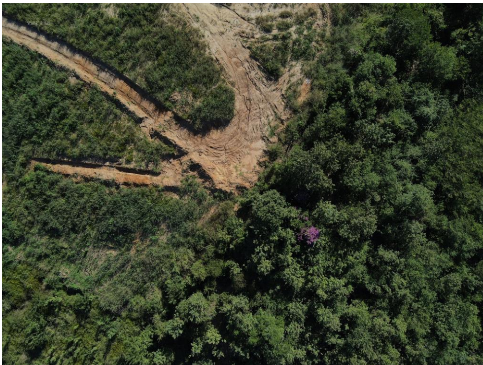
Foto 9: Dispositivo de controle de drenagem (SUMP) da Pilha 5 a menos de 80 metros da residência, cujo provável galgamento foi responsável pelo evento relatado. Notar descontinuidade nas bordas compatíveis com o galgamento.
